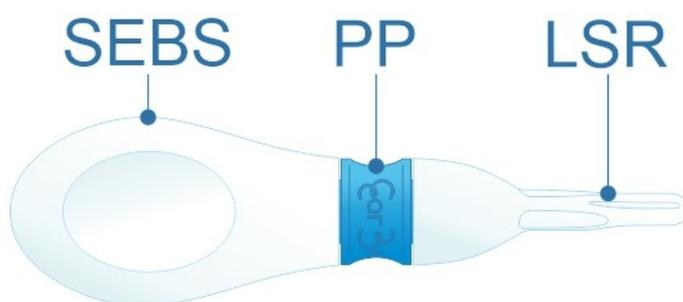
1.2 Il puntale in silicone presenta una parte più sottile a sezione trilobata, che va inserita all'interno dell'orecchio e una base a campana che impedisce di andare troppo in profondità con lo strumento all'interno del cavo uditivo.
