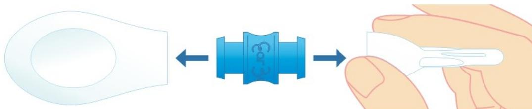
2.2 In caso di rimontaggio, si raccomanda di procedere rimontando sempre prima la pompetta in elastomero sul connettore in polipropilene e in ultimo di aggiungere il puntale, tenendolo sempre dalla base a campana e impugnando il dispositivo dal connettore in polipropilene e non dalla pompetta. Questo accorgimento evita di creare una depressione all'interno del dispositivo che ne comprometterebbe il corretto funzionamento.
